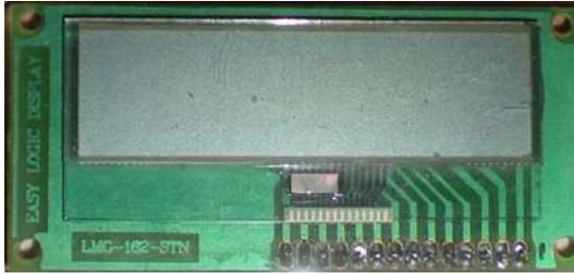
Figura 4.7 LCD utilizado en el módulo de control.
