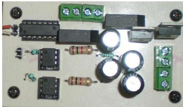
Figura 4.11 Circuito impreso para el acoplamiento óptico.
