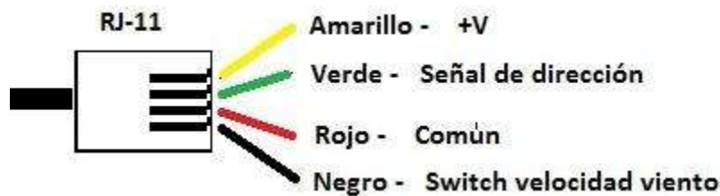
Fig. 4.10.- Diagrama de la disposición para la lectura del anemómetro (viento y dirección).
