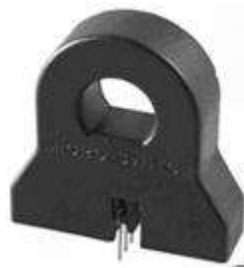
Fig. 4.17.- Sensor de efecto Hall.
