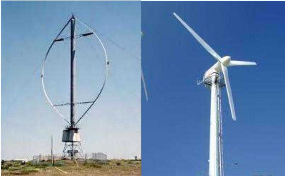
Fig. 2.5.- aerogenerador de eje vertical (izquierda) y de eje horizontal (derecha).
