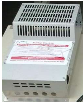
Fig. 3.2.- Controlador/inversor principal de la turbina y las pilas.
