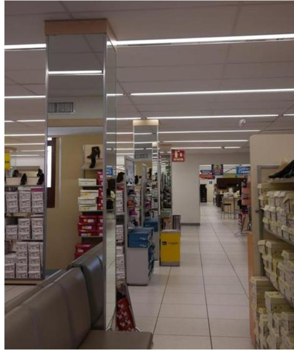
Imagen 94. Interior del Edificio Mercantil "La Ópera" distribución espacial interior de planta libre, columnas de concreto armado que se prolongan desde el primer nivel recubiertas con espejo y losa de concreto armado con falso plafón. Foto: EGV.
