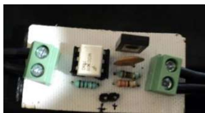
Figura 3.22 Circuito driver para el disparo de la herramienta.
