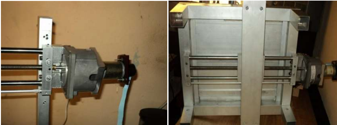
Figura 3.6 Acoplamiento de los ejes X e Y del manipulador.
