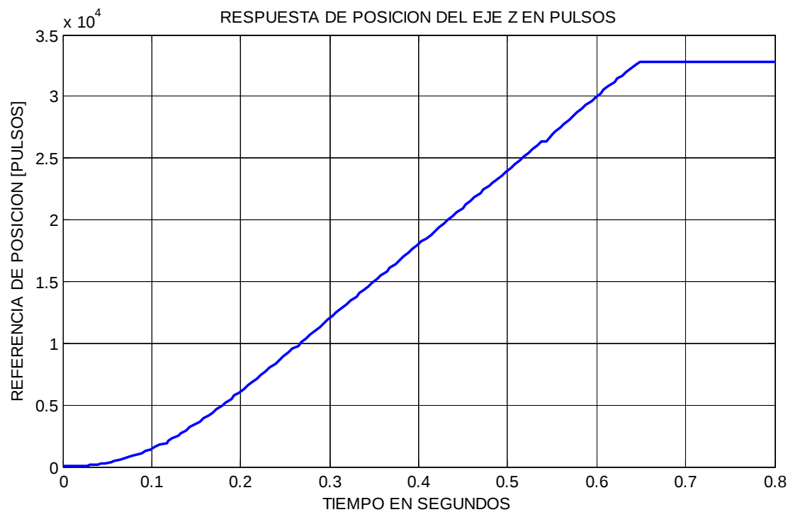
Figura 5.12. Respuesta en lazo cerrado a un comando de posición para el eje Z
