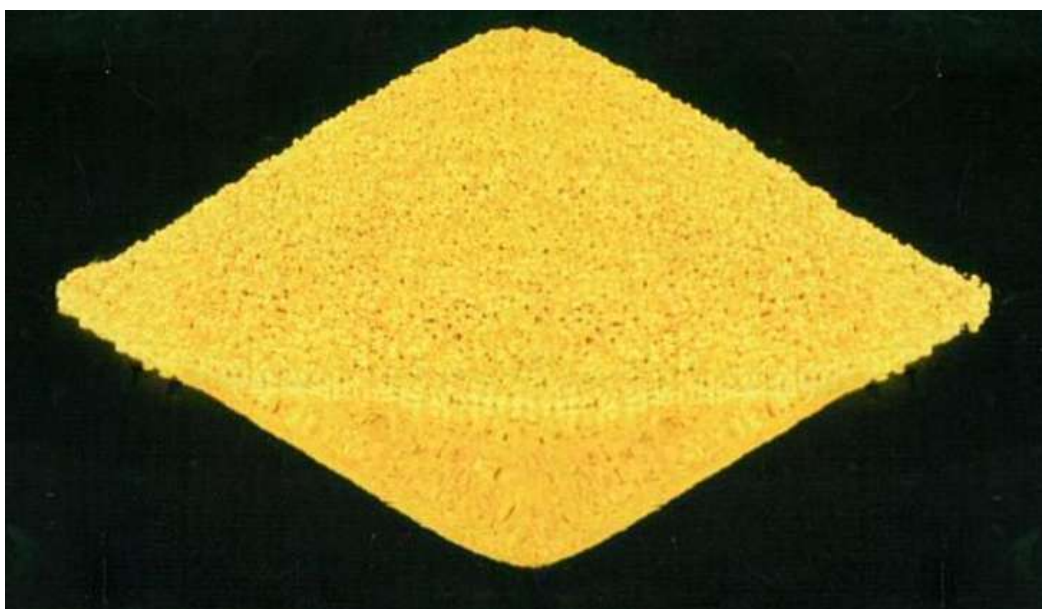
Figura 4.8 Uranio triturado con mezclado con óxido, torneándose de un color amarilloso.
