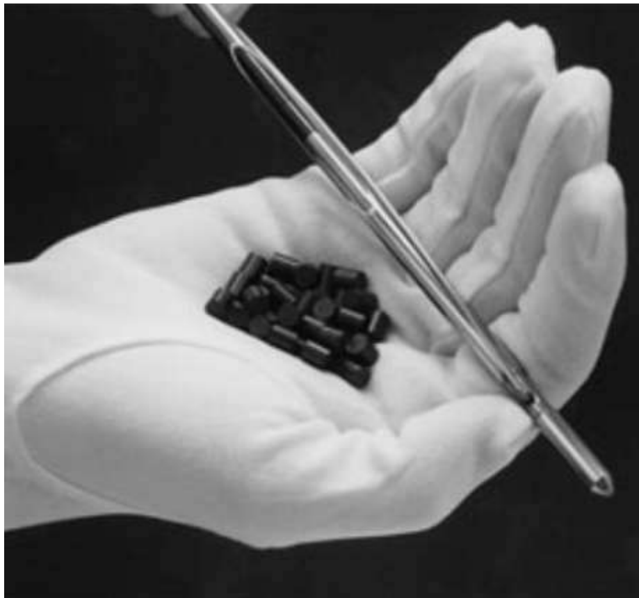
Figura 4.10 Pellets mejor conocido como combustible nuclear encapsulado en pequeños cilindros cerámicos.
