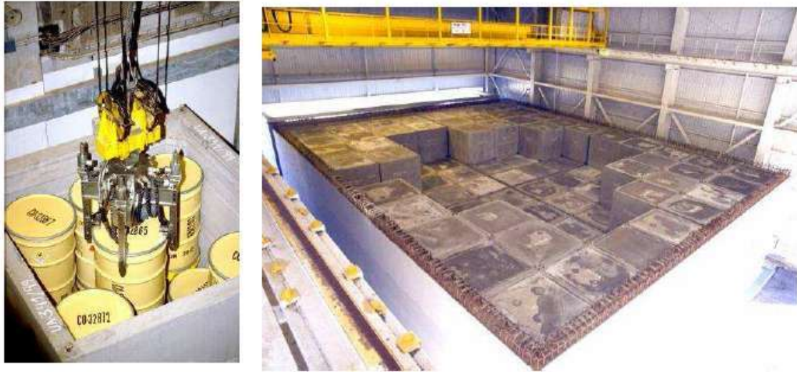
Figura 4.22 sistema de aislamiento del material radioactivo.
