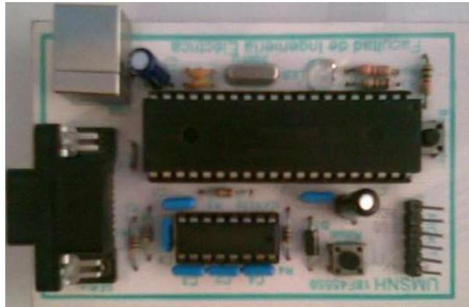
Figura 4.10. Tarjeta PIC18F4550 para el envío de datos.
