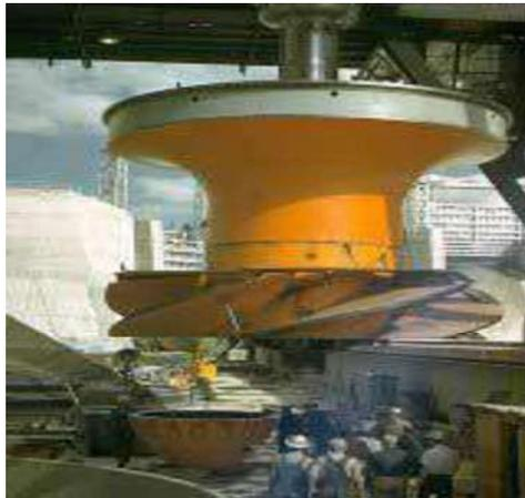
Figura 2.7 Rodete en una turbina Kaplan
