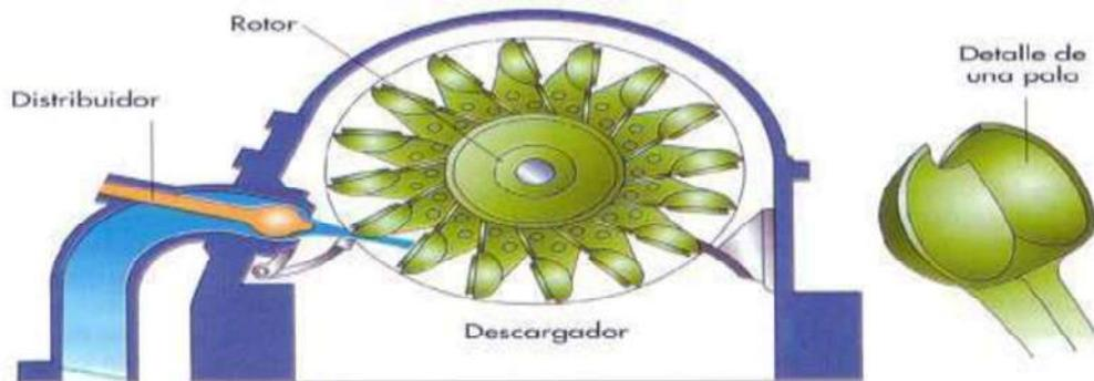
Figura 2.5 Componentes de una turbina Peltón
