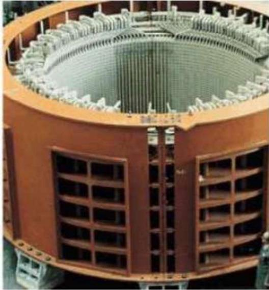
(a) Estator de la máquina síncrona
