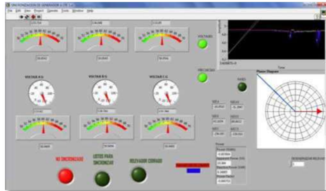
Figura 5.44 Panel frontal de medidores de voltaje y frecuencia.
