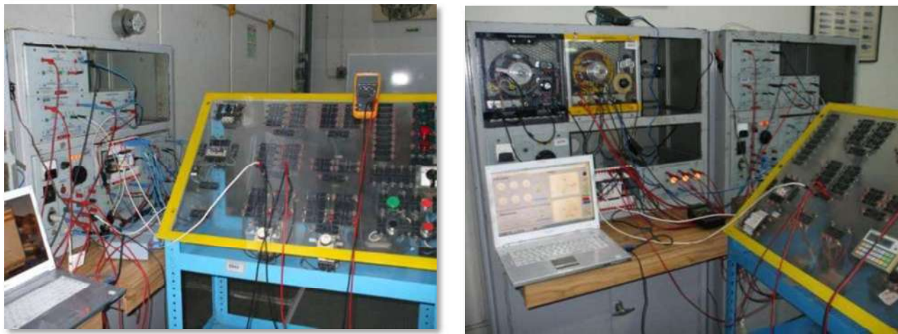
Figura 5.46 Pruebas de disparo y temporizador para garantizar el buen funcionamiento del sistema.
