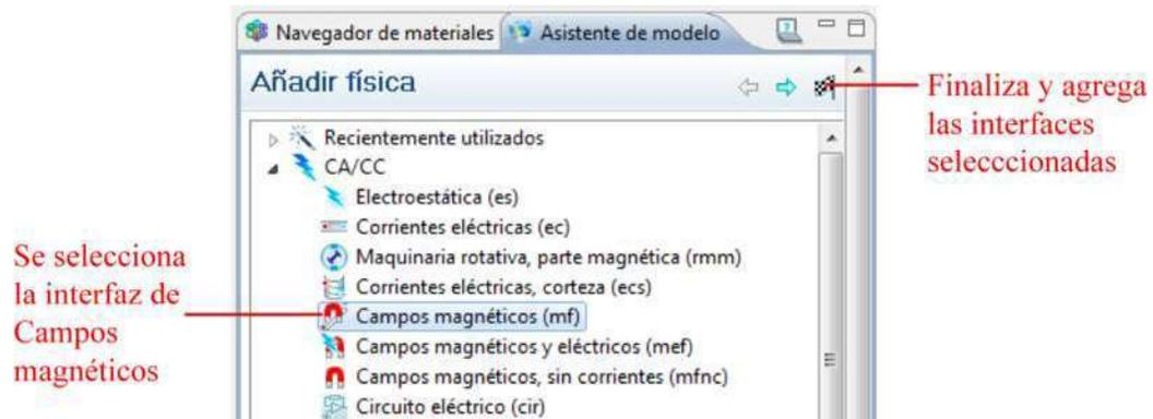
**Figura 3.19** Procedimiento para agregar una interfaz de Campos magnéticos.
