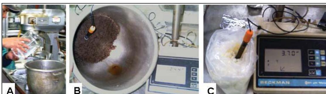
**Figura 20.** (A) adición del licor de blanqueo a la pulpa; (B) determinación de pH inicial y (C) medición de pH final
