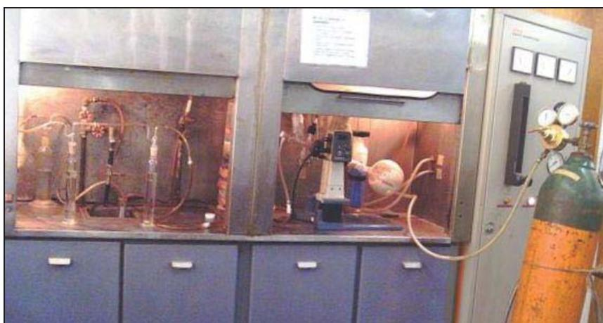
Figura 22. Equipo empleado para ozonificar la pulpa
