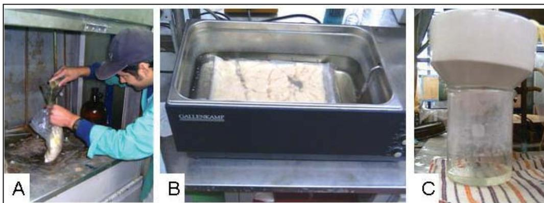
**Figura 19.** (A) adición del dióxido de cloro en la campana de extracción; (B) baño térmico con la bolsa de polietileno que contiene la pulpa y (C) embudo Buchner y vaso de precipitados para la extracción de licor residual
