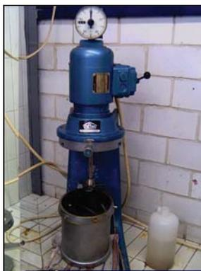
**Figura 23.** Equipo para desintegración de pulpas
