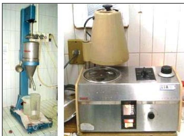
**Figura 26.** Equipo para medir los  $^{\circ}$ SR, en pulpas y Balanza para determinar el peso seco de la pulpa residual colectada del recipiente de drenado
