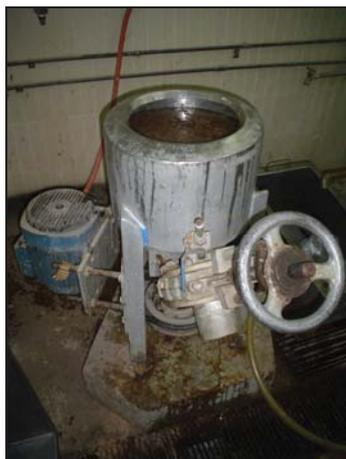
**Figura 9.** Equipo utilizado para desfibrar la pulpa.
