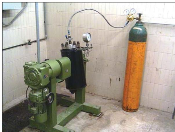
Figura 21. Equipo utilizado para el blanqueo con oxígeno
