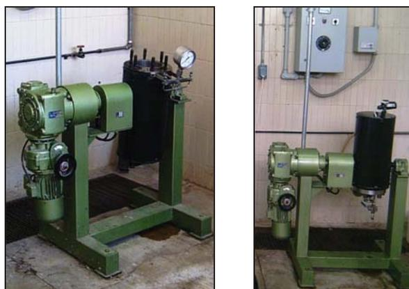
Figura 6. Digestor rotatorio empleado para las cocciones del pulpeo Kraft.
