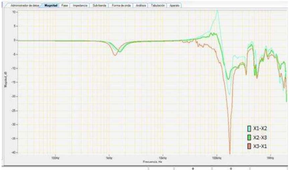
Figura 4.20.- Resultados de la prueba de SFRA del Transformador 2 Lado de Baja
