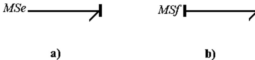
Figura 2.4 Puertos-1 Activos a) Fuente de esfuerzo b) Fuente de flujo
