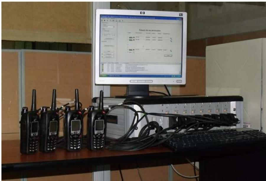
Figura 4.8 La SPT, equipo de cómputo con el sistema para programación de terminales
