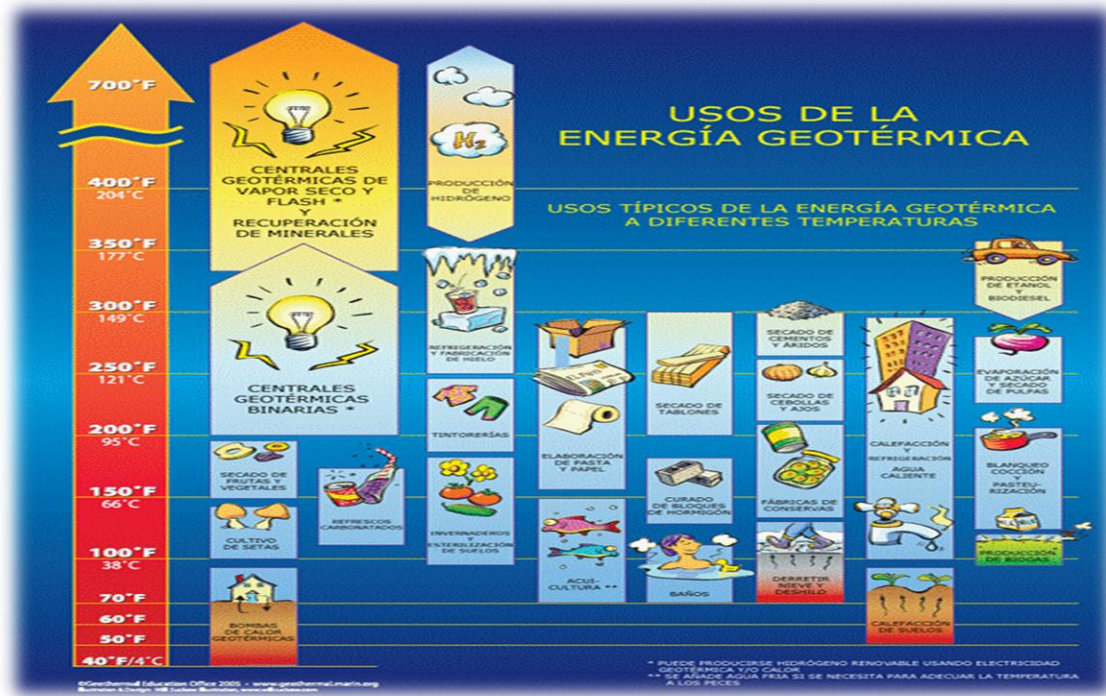
Figura 3.7 Aplicaciones de la energía geotérmica de acuerdo a su temperatura.
