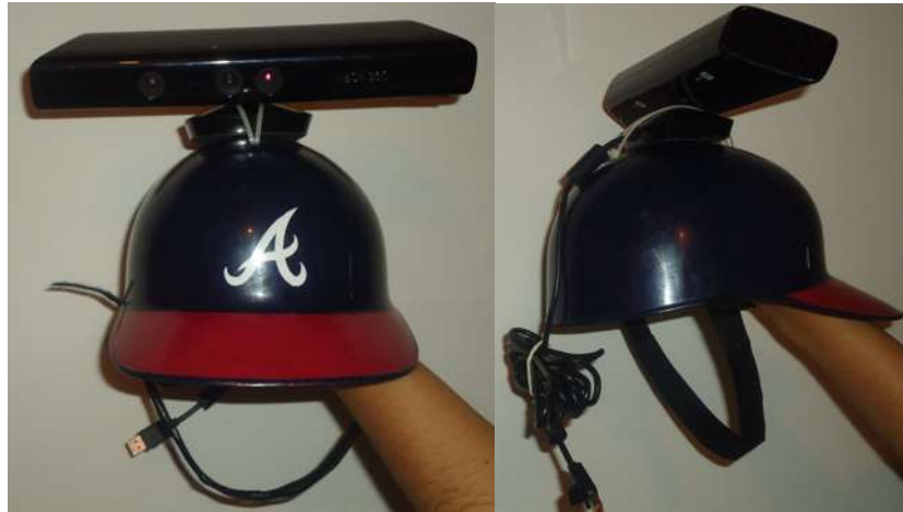
Figura 4.8. Casco y el sensor Kinect.
