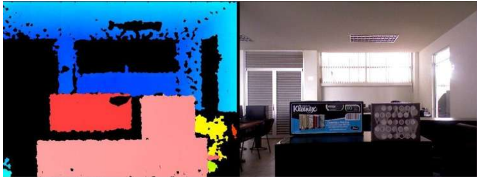
Figura 4.1. Imagen de profundidad con gama de colores e imagen RGB.
