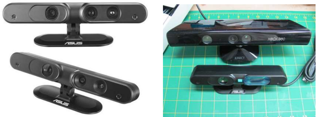
Figura 5.1. Xtion y su diferencia en tamaño con Kinect.
