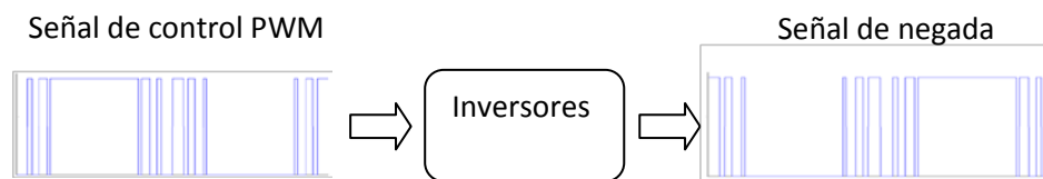
Figura 3.20, proceso para invertir la señal.
