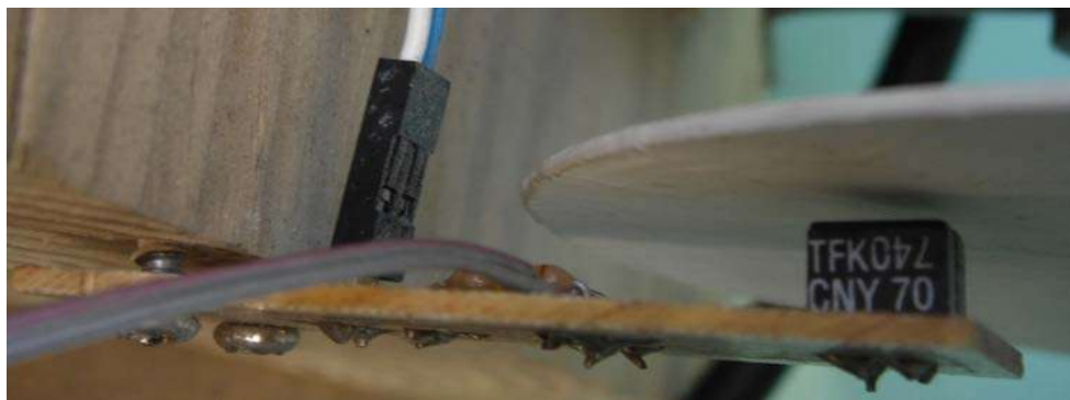
Figura A5: Imagen de la colocación del circuito.
