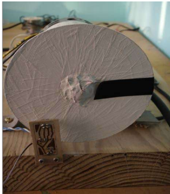
Figura A6: imagen de la colocación del circuito en el motor.
