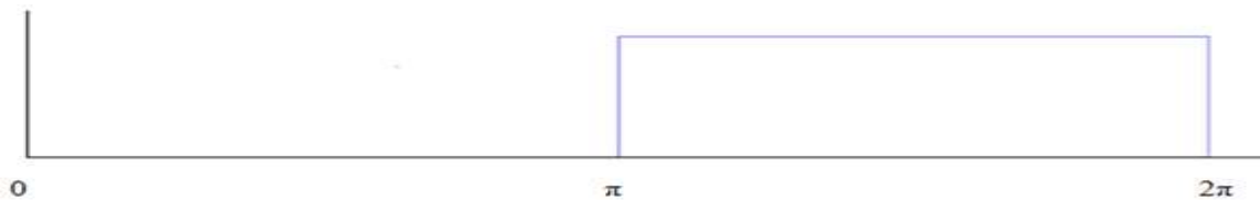
Figura 2.18, Señal de estado bajo de 0 a \pi y de estado alto en el complemento.
