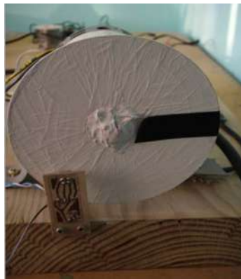
Figura 3.9, imagen del disco que se acoplo al eje del motor.
