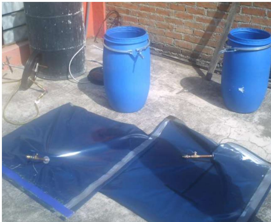
Figura 4.13 Biodigestor cargados con Biomasa.
