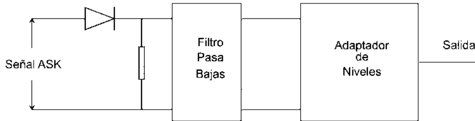
Figura 6.1 Demodulador ASK detector de envolvente.
