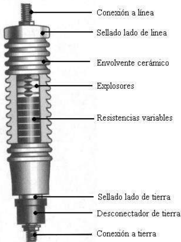
Figura 2.5 Apartarrayos de carburo de silicio.
