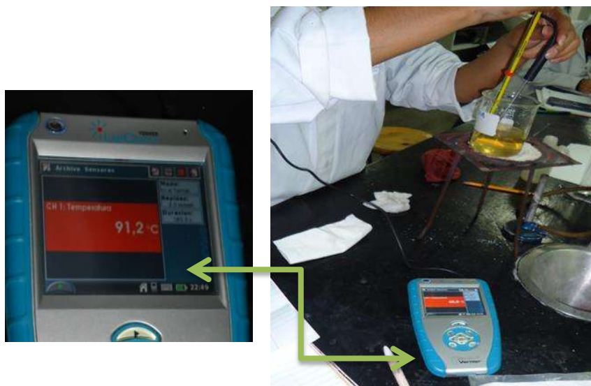
Figura 4.4 temperatura punto en el punto de ebullición de solución concentrada de sacarosa
