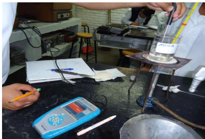
Figura 4.3 temperatura en el punto de ebullición de la solución concentrada de salmuera.
