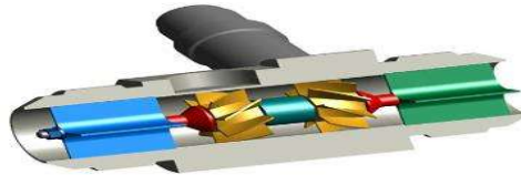
Figura 2.14 Medidor de turbina
