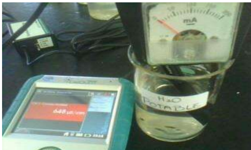
Figura 4.17 Medición en agua potable.
