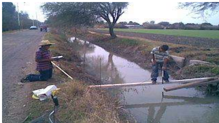
Figura 3.35 Medición de caudal en sitio 2.
