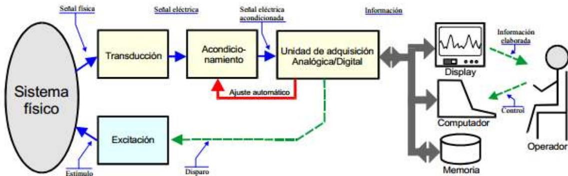
**Figura 1.1 sistema de instrumentación**
