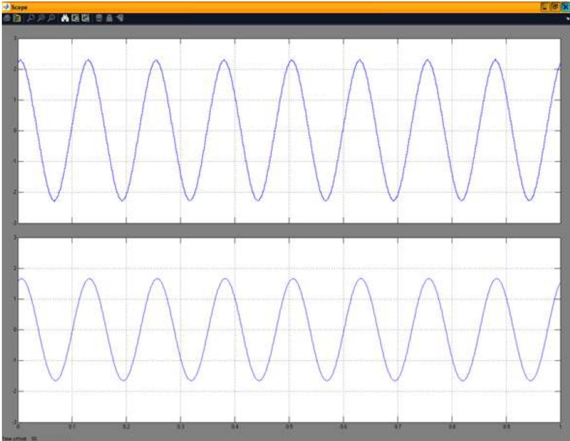
**Figura 4.32** Entrada y salida del filtro vista en el osciloscopio de simulink con una  $F = 8Hz$
