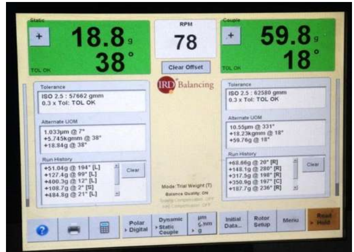
Figura 4.8. Después de realizadas las corridas de calibración que involucran el algoritmo de coeficientes de influencia la instrumentación nos arroja las lecturas de corrección para ambos planos de corrección simultáneamente.
