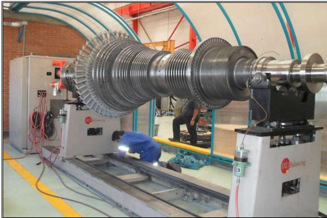
Figura 2.6. La velocidad nominal de esta turbina de 16 toneladas de peso, es 3600 RPM, su balanceo se llevó a cabo en los talleres de reparación de la empresa SIEMENS de Querétaro a una velocidad de sólo 360 RPM, con resultados muy satisfactorios.
