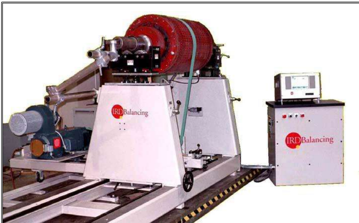
Figura 2.2. Las armaduras de motores eléctricos son un caso típico de aquellos rotores que requieren ser balanceados fuera de su entorno de operación, dada su configuración hermética.
