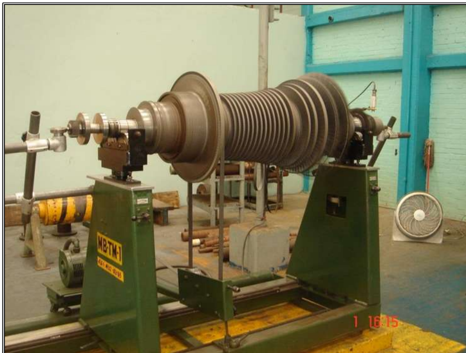
Figura 4.3. Los rotores flexibles, que operan por arriba de sus velocidades críticas requieren ser balanceados en varios planos de corrección, para asegurar su correcta operación.
