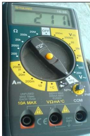
Figura 4.76 b) Multímetro Tulumex midiendo el hFE del transistor 2N4124.
