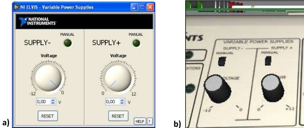
Figura 3.26 Fuentes variables (0 a -12 VCD) y (0 a +12 VCD) por a) software y b) manual.
