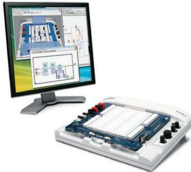
Figura 5.2 Estación de trabajo NI-ELVIS II (2009).
