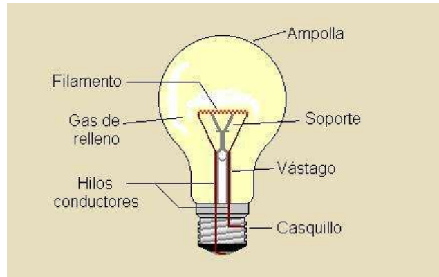
Figura 9 Lámpara Incandescente (Gas de relleno: Argón, Nitrógeno, Neón)
