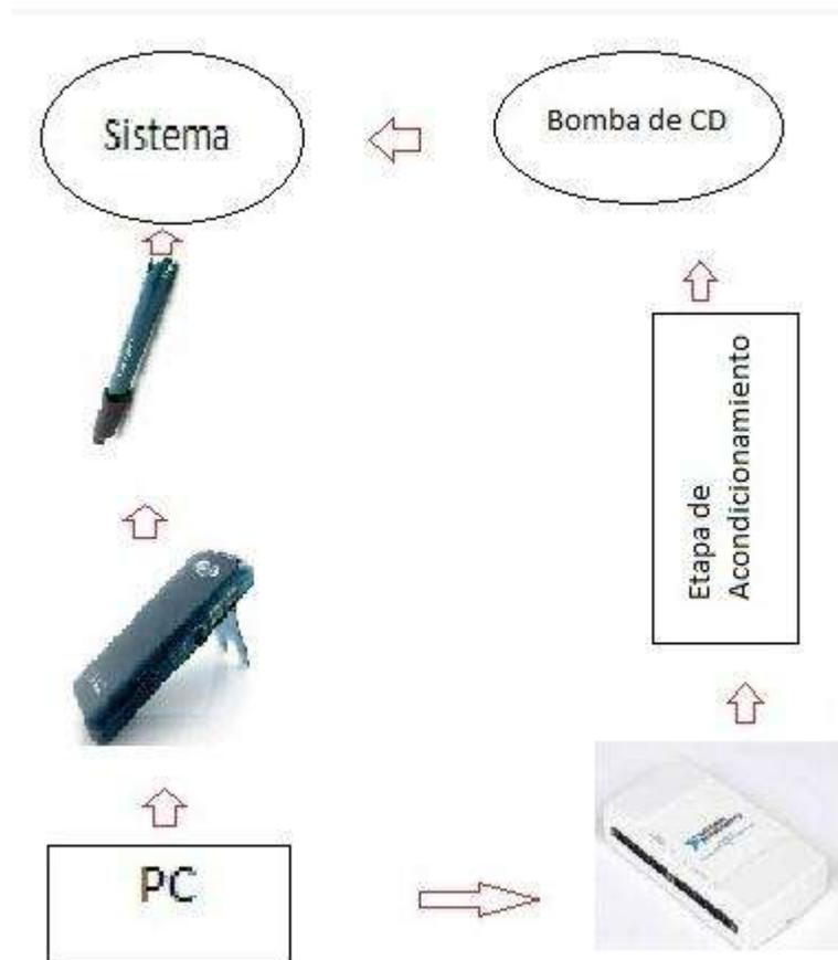
**Figura 4.13** *Diagrama completo del control de pH.*
