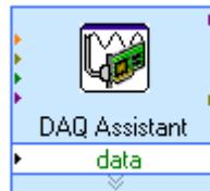
*Figura 4.8 Bloque de salida de la tarjeta NI USB-6211.*
