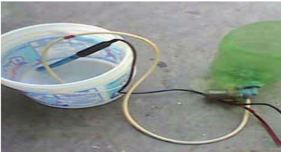
*Figura 4.15 Sistema y bomba del control de pH.*
