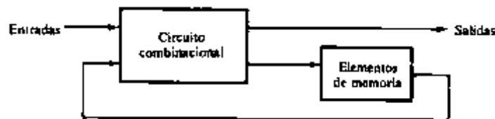
**Figura 2. 5 Diagrama de bloques de un circuito secuencial.**
