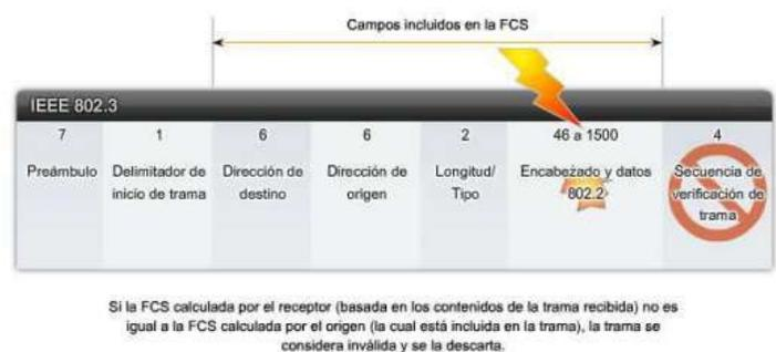
**Figura 3. 10 Secuencia de verificación de trama Ethernet.**
