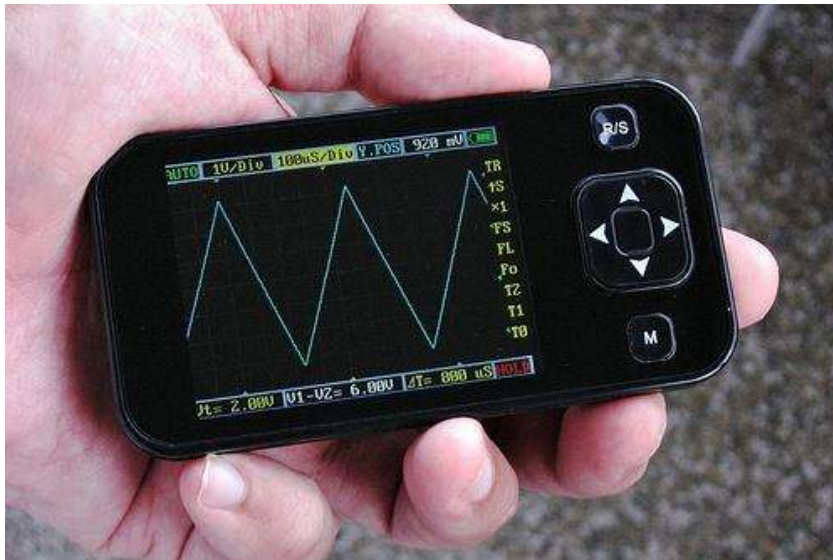
Figura 2.8 Osciloscopio de bolsillo
