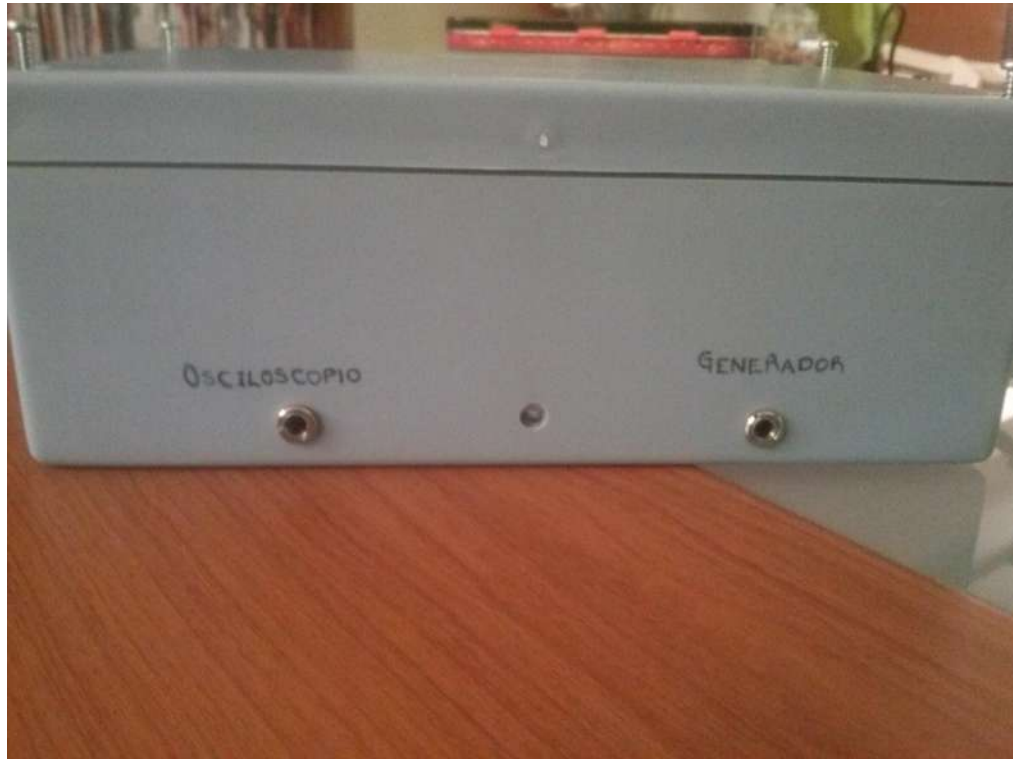
Figura 5.3 Vista externa del osciloscopio con entrada de 3.5 mm
