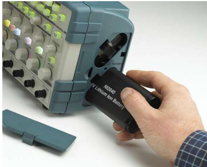
Figura 2.5 Osciloscopio digital de mesa alimentado por baterías
