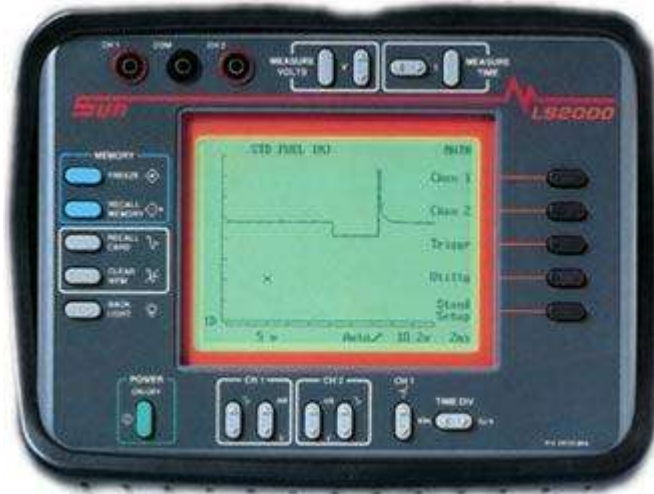
Figura 2.3 Osciloscopio digital para diagnóstico de fallas en automóviles
