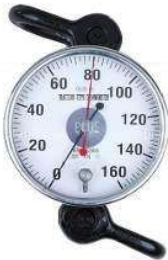
Figura 47 Dinamómetro para medir tensión de conductor
