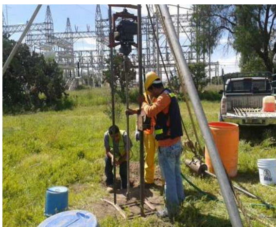
Figura 13 Sondeo de penetración estándar
