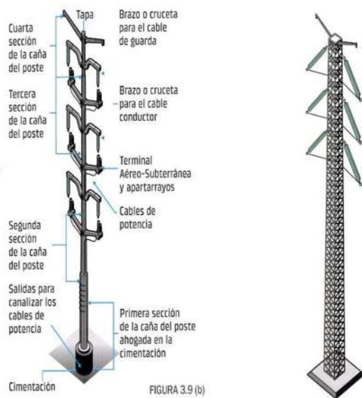
Figura 8 Postes troncocónico 2 circuitos tipo camellón y transición
