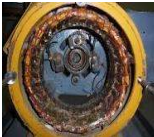
Figura 2.3 Estator de un motor de inducción.
