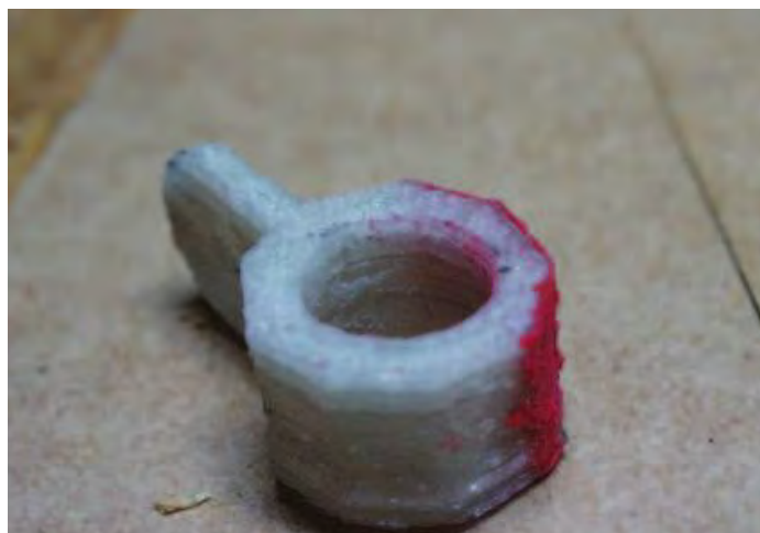
Imagen 107. Pieza fabricada en 3D print. de anclas a columna.
