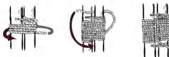
Imagen 23. Detalle constructivo de los soportes bajo las gradas donde se observan los tipos de amarres en la petatera. Copyright © BravoTeam Soft 2014.jpg
