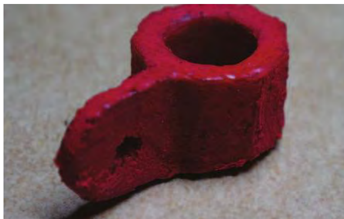
Imagen 108. Pieza fabricada en 3D print. de anclas a columna. Recubierta para usarse como molde
