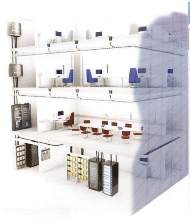
Figura 5 Rack y gabinete para cableado estructurado
