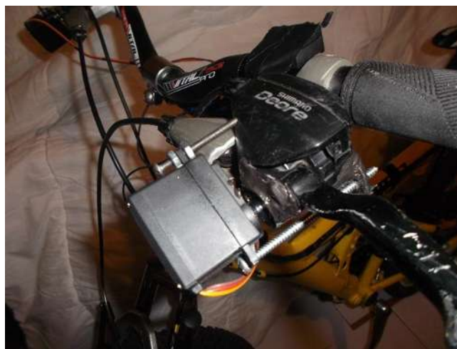
Figura 3.6 Montaje del servomotor en un mando de cambios
