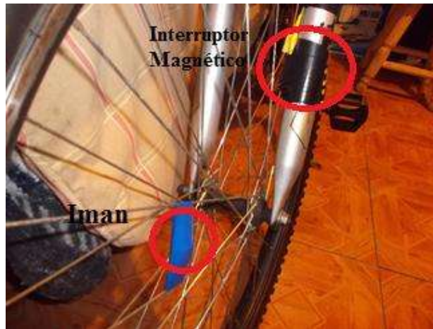
Figura 3.8 Montaje del interruptor magnético
