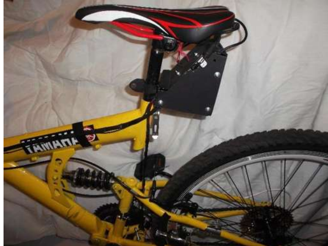
Figura 3.2 Montaje de la caja para la ubicación de la batería
