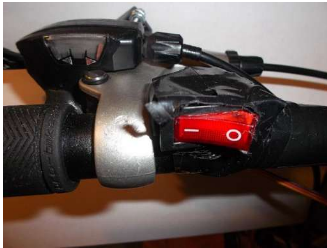
Figura 3.10 Montaje del interruptor de selección de cadencia
