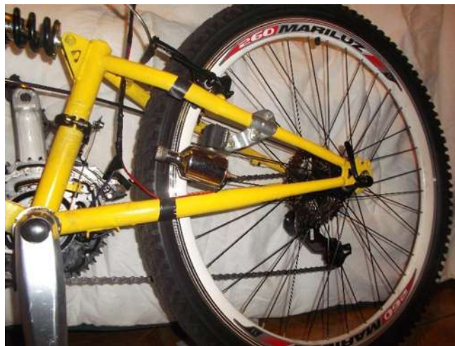
Figura 3.13 Colocación del dínamo en la bicicleta
