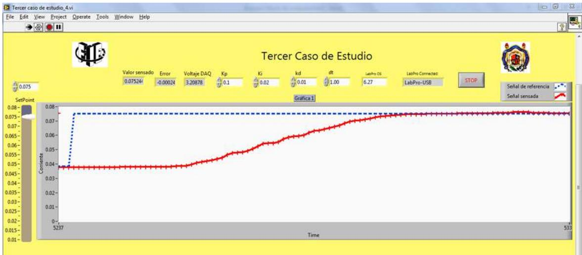
Figura 4.55 Control PID con un set point de 75mA.
