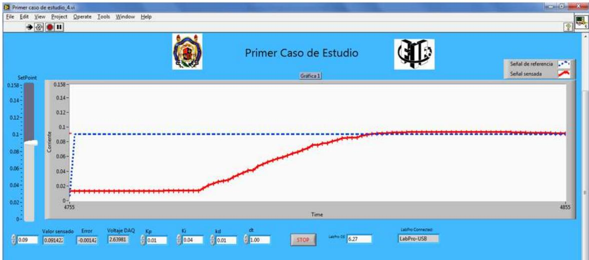
Figura 4.32 Control PID con Set Point de 90mA.
