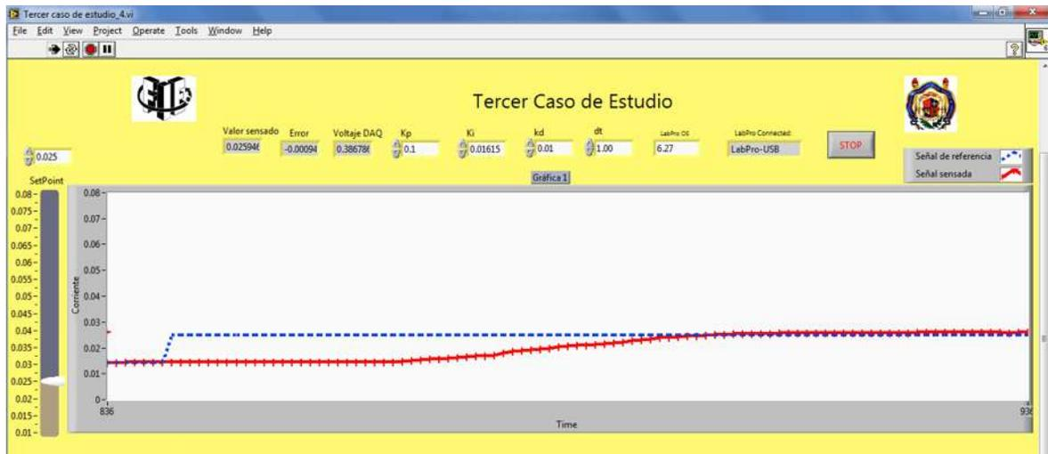
Figura 4.53 Control PID con set point de 25mA.
