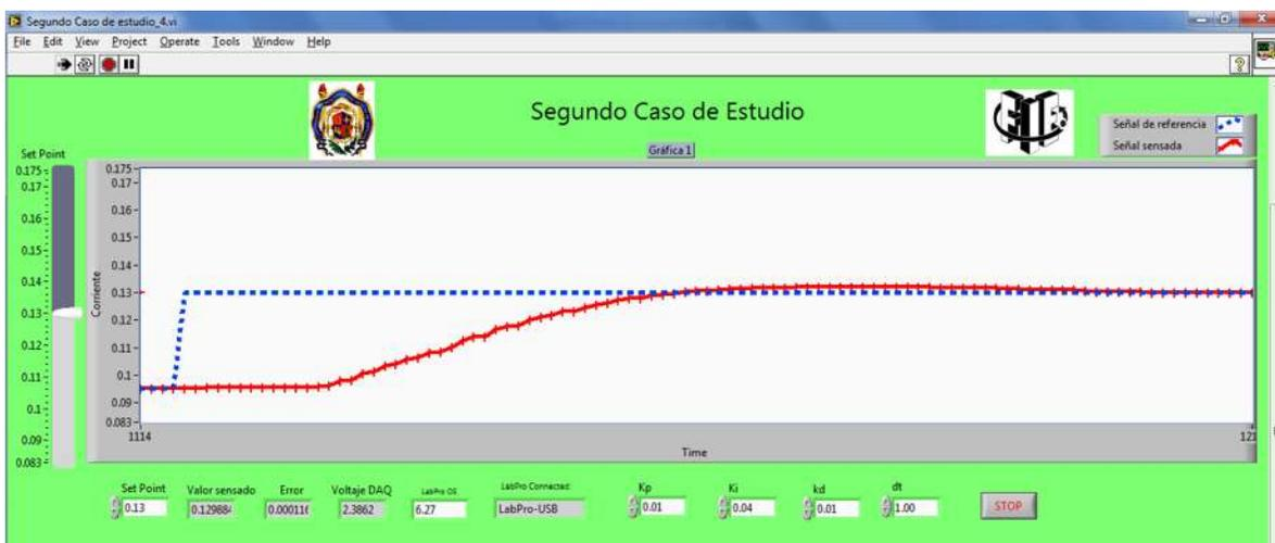
Figura 4.42 Control PID con set point de 130mA.
