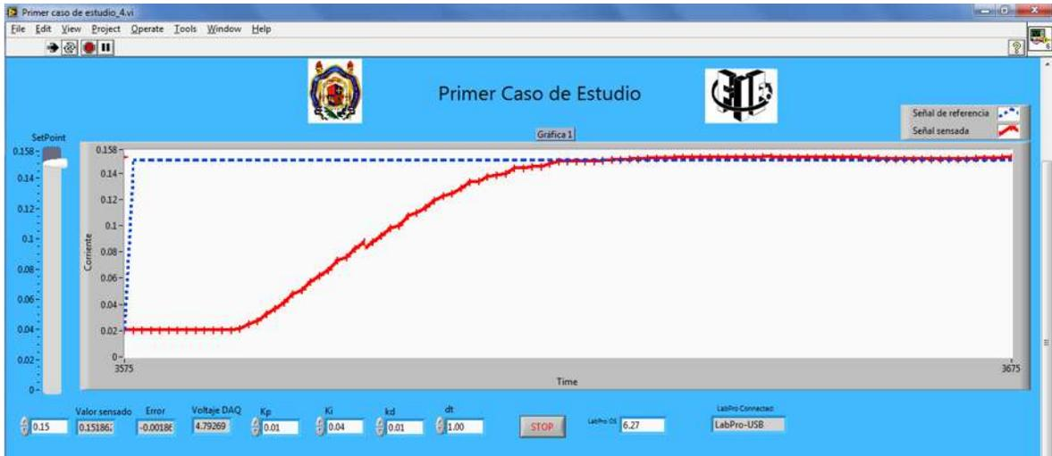
Figura 4.31 Control PID con Set Point de 150mA.
