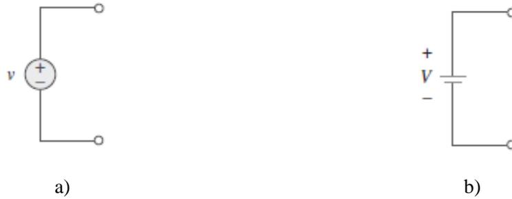
Figura 2.21 Símbolos para fuentes de tensión independientes: a) usado para tensión constante que varía con el tiempo, b) usado para tensión constante (cd).
