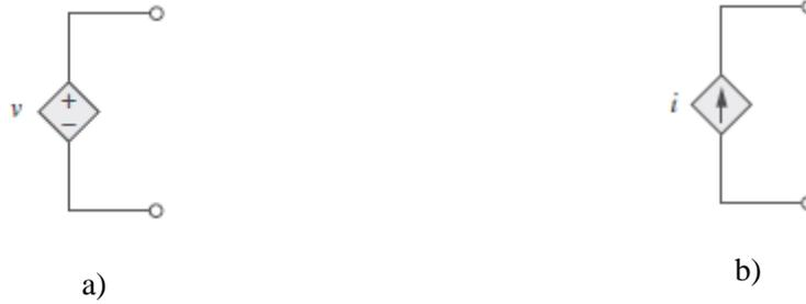
Figura 2.23 Símbolos de: a) fuente de tensión dependiente, b) fuente de corriente dependiente.
