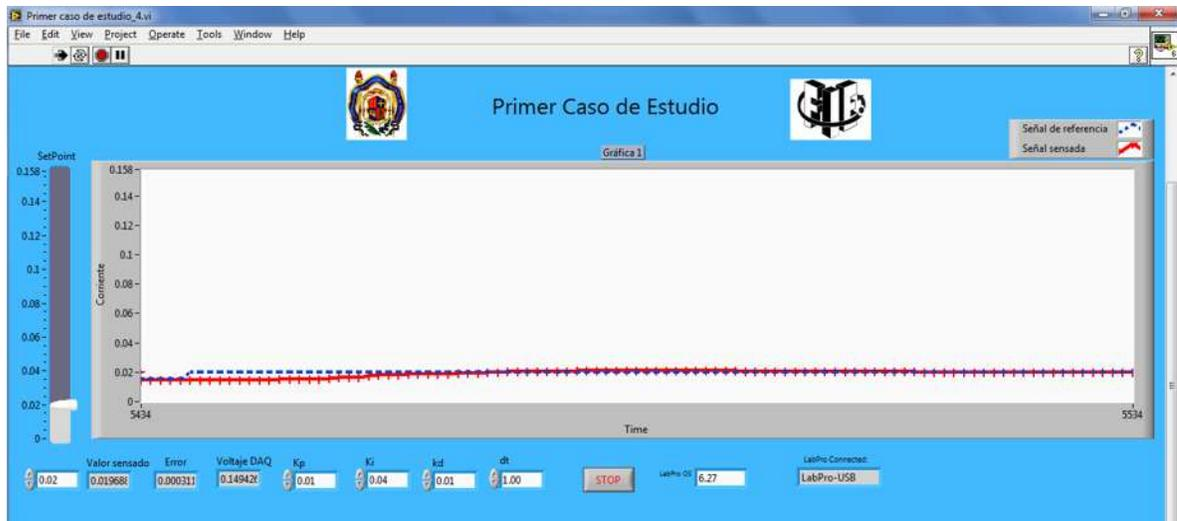
Figura 4.33 Control PID con Set Point de 20mA.
