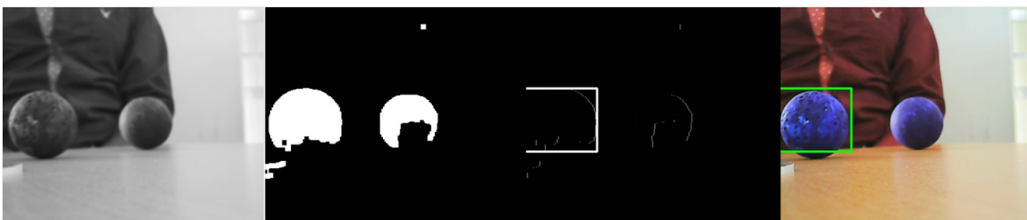
Figura 4.9: Proceso de filtrado de contornos con un umbral mayor.
