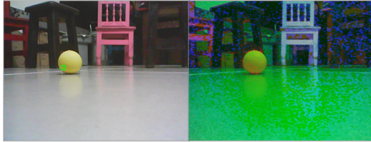
Figura 4.4: Imagen tomada una vez que se aplicó el filtro HSI
