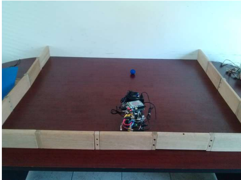
Figura 5.5: Al encontrarse el robot a 0^\circ del objeto, la cámara del robot queda de frente al objeto a identificar, la tarea principal es seguir la trayectoria al objeto correctamente.
