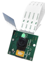
Figura 3.2: Camara Pi diseñada para la conexión en un puerto SCI de la Raspberry Pi.
