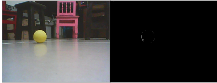
Figura 4.7: Filtro por umbral utilizando el espacio de color BGR.
