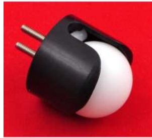
Figura 3.9: Rueda loca del robot.
