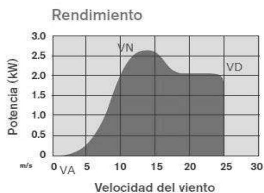
Figura 3. 3 Curva de potencia del aerogenerador Skystream 3.7®.
