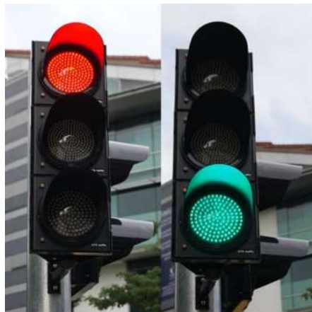
Figura 4.2 Semáforo con 3 lámparas a base de iluminación LED
