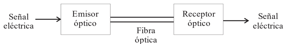
Figura 2.2 Sistema de comunicación por fibra óptica
