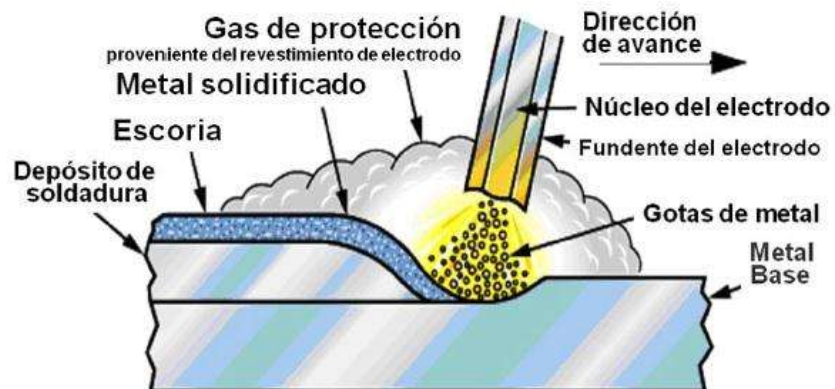
Figura 14.- Proceso soldadura SMAW
