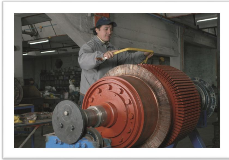
FIGURA 10.- MANTENIMIENTO CORRECTIVO DE MOTORES ELÉCTRICOS
