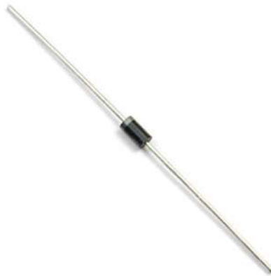
Figura 4.6 Diodo de silicio 1N4007
