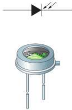
Figura 2.13 Símbolo del fotodiodo
