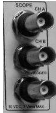
Figura 3.26 Área de conexión para realizar mediciones con el osciloscopio de la estación de trabajo NI ELVIS
