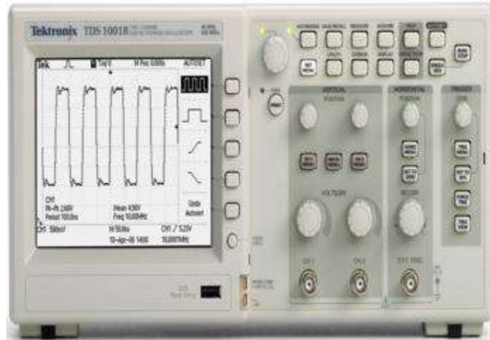
Figura 2.33 Osciloscopio digital Tektronix TDS1001B
