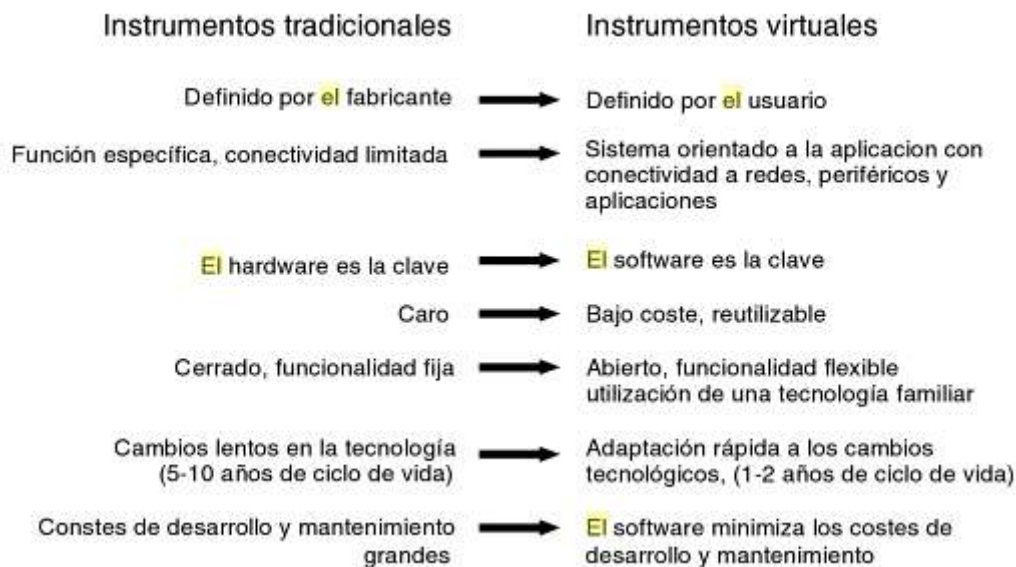
Figura 3.6 Diferencia entre instrumentos virtuales y tradicionales
