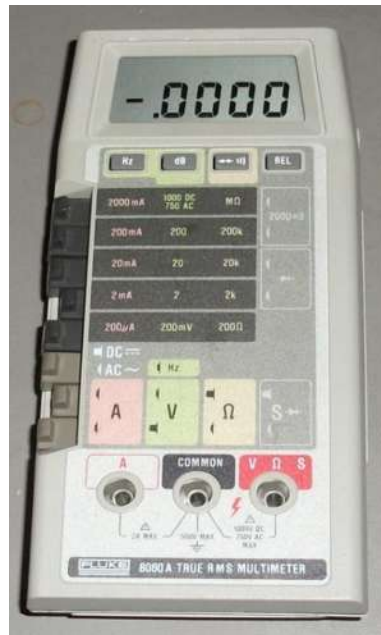
Figura 2.27 Multímetro digital Fluke 8060
