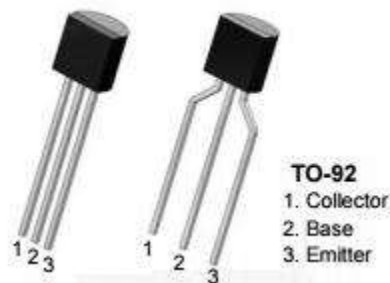
Figura 4.50 Configuración de las terminales del transistor BC337
