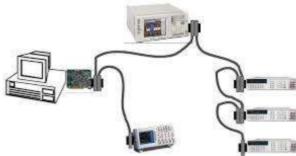
Figura 3.3 Conexión mediante el GPIB
