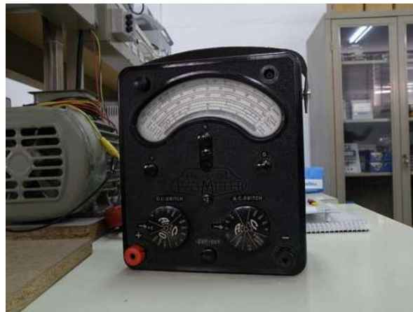
Figura 2.23 Multímetro AVO 7 fabricado en 1965
