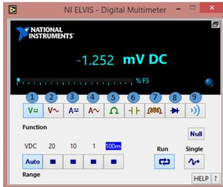
Figura 3.13 Ventana de opciones de medición del DMM
