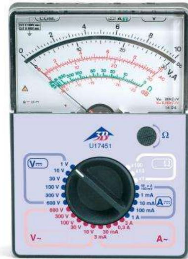
Figura 2.25 Multímetro analógico AM51 U17451
