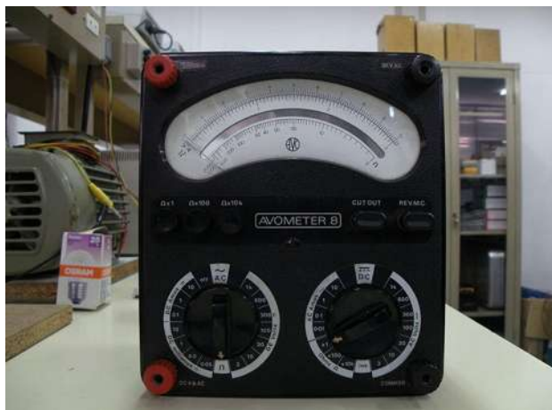
Figura 2.24 Multímetro modelo 8 AVOMETER
