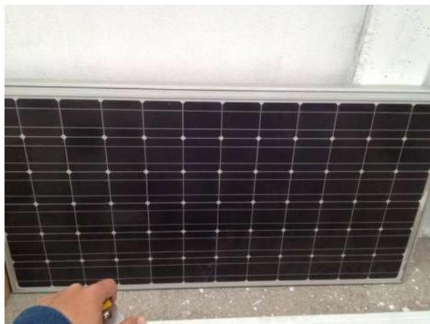
Figura 1.1.- Módulo Fotovoltaico
