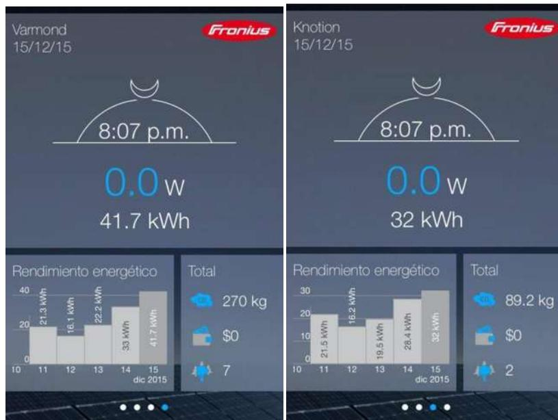
Figura 5.11.- Comparación de sistemas en las mismas condiciones al terminar del día
