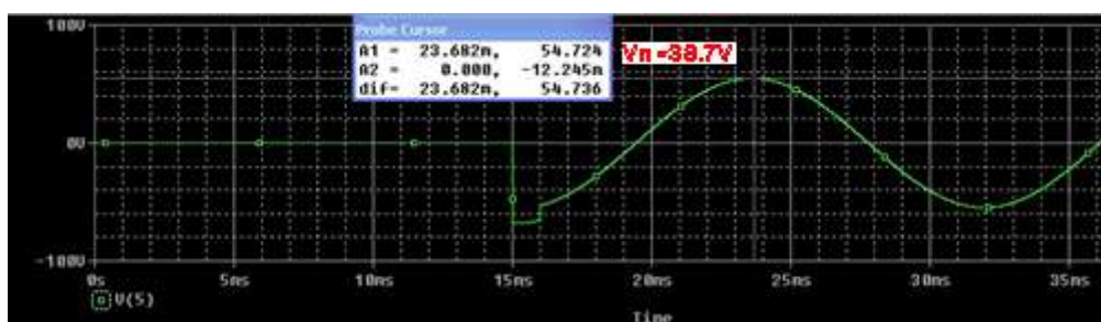
Figura 4.14. Respuesta en PSpice con carga de 80\Omega en R_c y sólidamente a tierra
