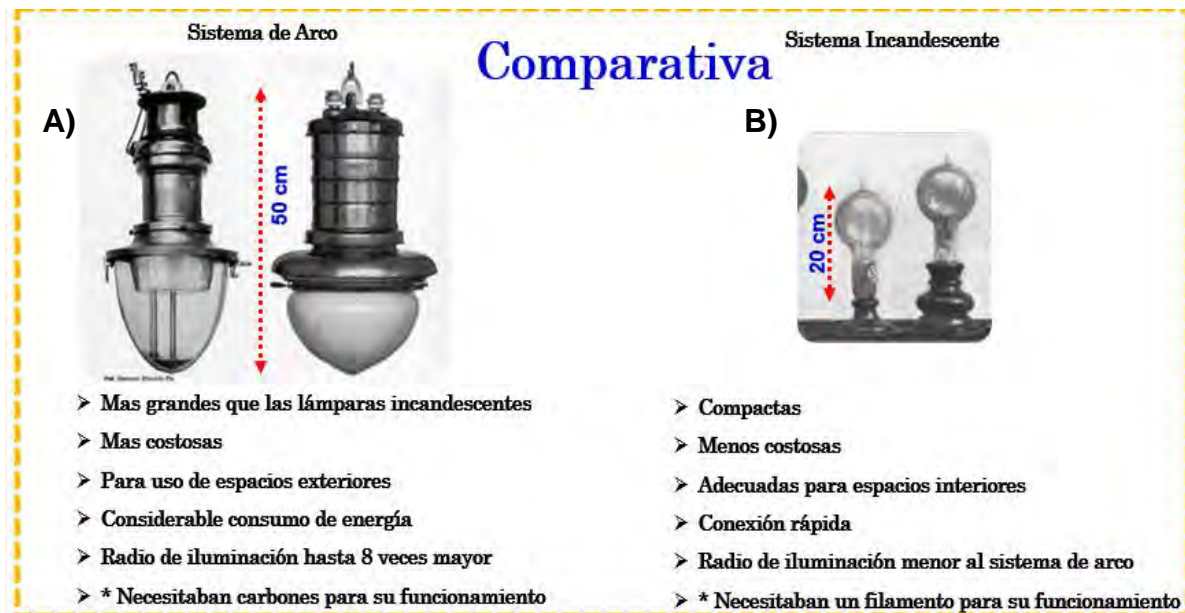
Figura 39. Comparativa de los sistemas de iluminación en la ciudad de Morelia en 1912. A) Sistema de iluminación de arco y B) sistema de iluminación incandescente. Fuente: Esquema propia, noviembre de 2016.
