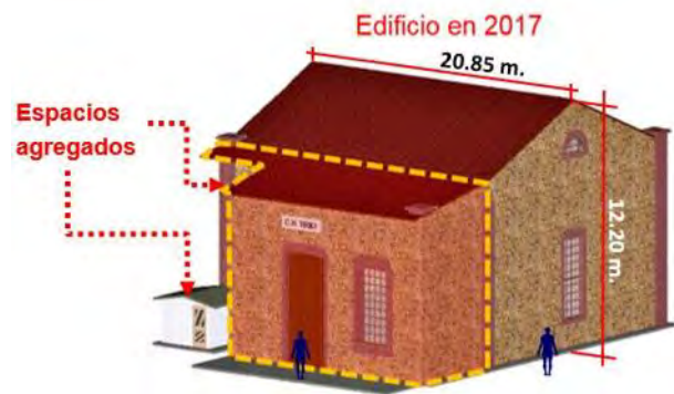
Figura 48. Planta de Luz Hidroeléctrica, La Trinidad en 2017.
