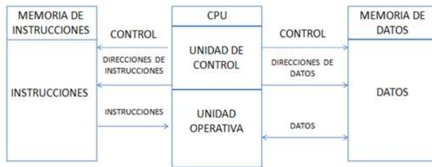
Figura 2.2 Diagrama de Bloques de un Microcontrolador con Arquitectura Harvard
