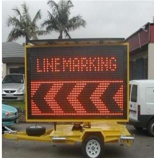
Figura 1.2 - Señalamiento de Transito con Matriz LED
