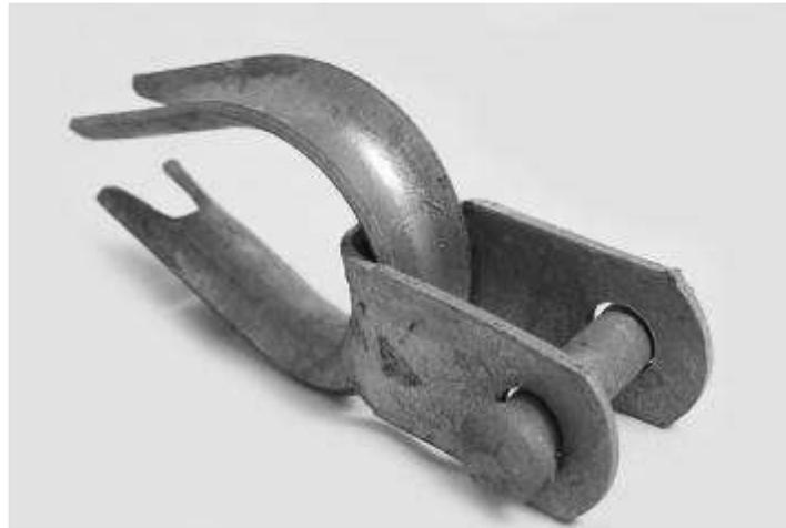
**Figura 3. 50.- Horquilla con guardacabo.**
