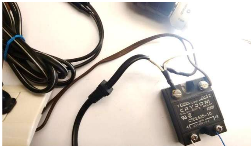
Figura 5. 15 Funcionamiento conjunto del microcontrolador y el relevador SSR
