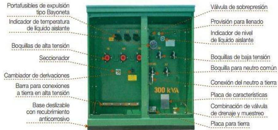
Figura 11.- Elementos que conforman el frente de un Transformador de Pedestal.
