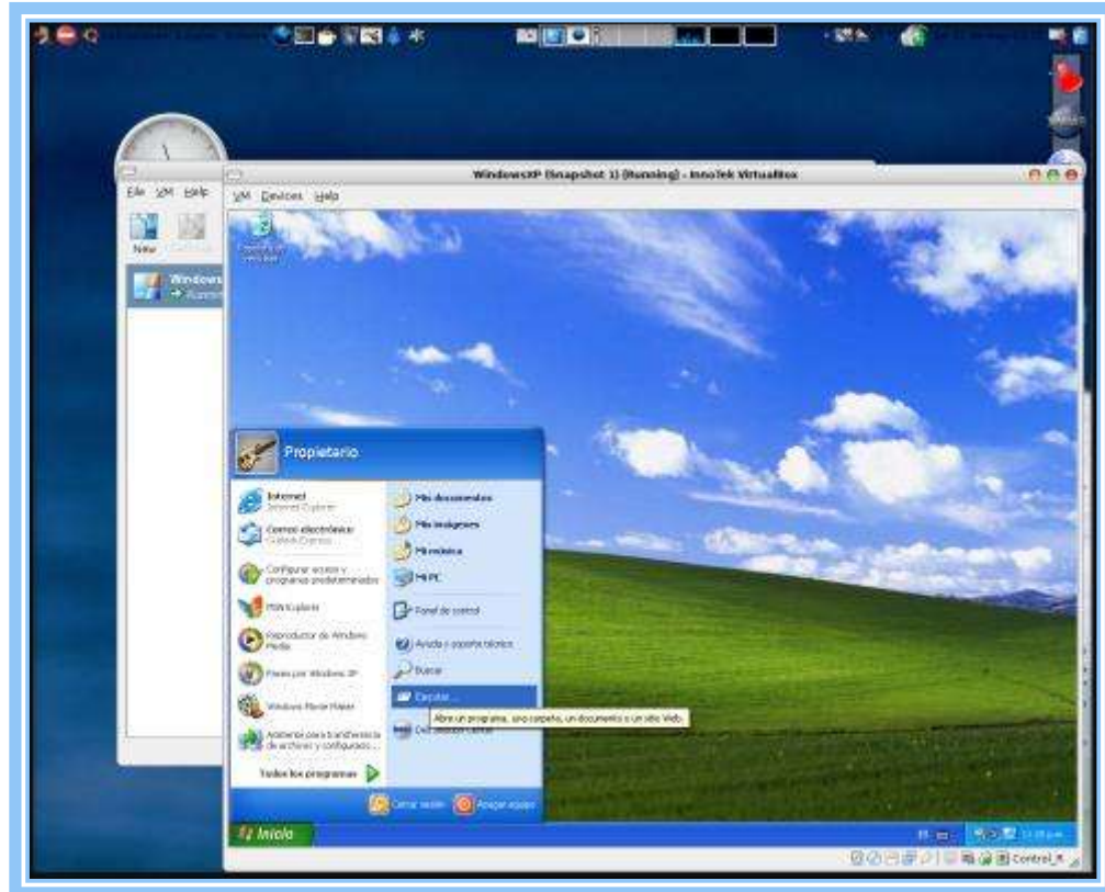
Figura. 3. Máquina real ejecutando Linux conteniendo una Máquina virtual que ejecuta Windows.
