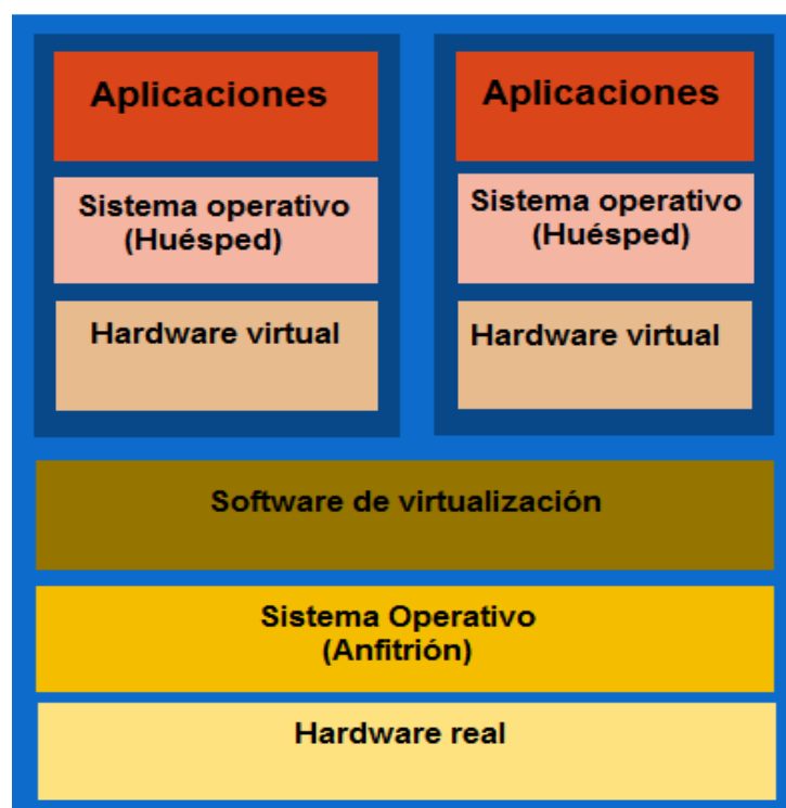
Figura 8. Entorno de virtualización con sistema operativo invitado
