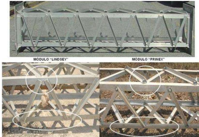
Figura 9.- Diferencia entre módulos Lindsey y prinex
