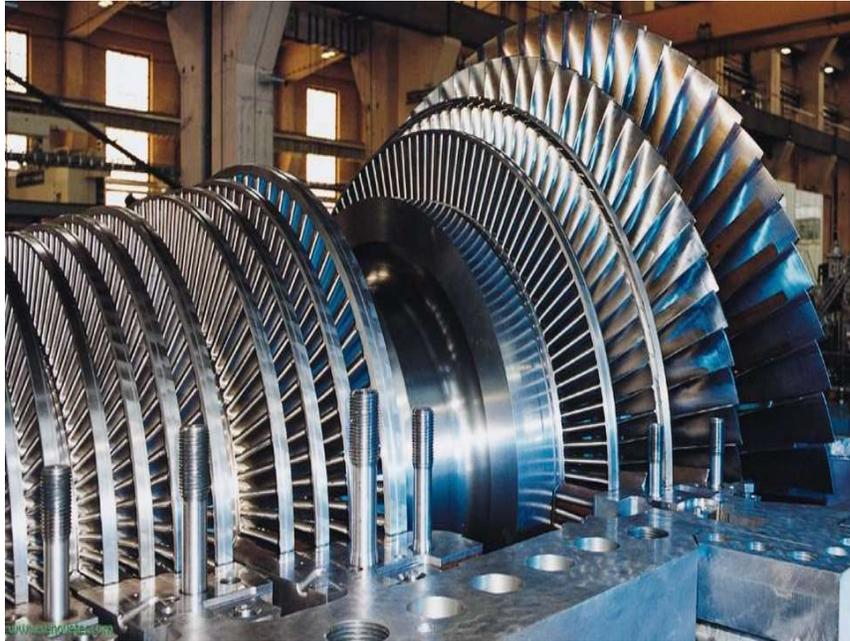
Figura 3.7. Turbina de vapor.
