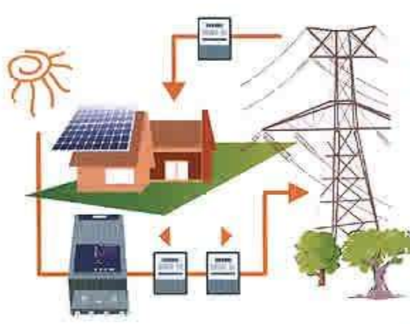
Figura 2.6 Sistema Fotovoltaico Interconectado a la red
