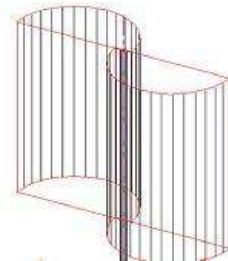
Figura 3.4. Aerogenerador Tipo Savonius
