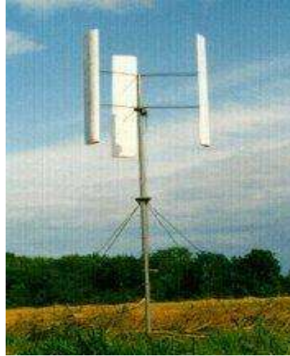
Figura 3.6. Aerogenerador con rotor Giromill
